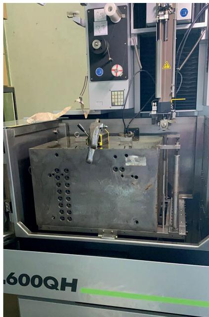
**Quadratisch gut:** Mit der VL600QH hat EDM-Spezialist Wölk zudem eine Maschine in Betrieb genommen, die mit einer Z-Achs-Höhe bis 500 mm auch hohe Bauteile bearbeiten kann
